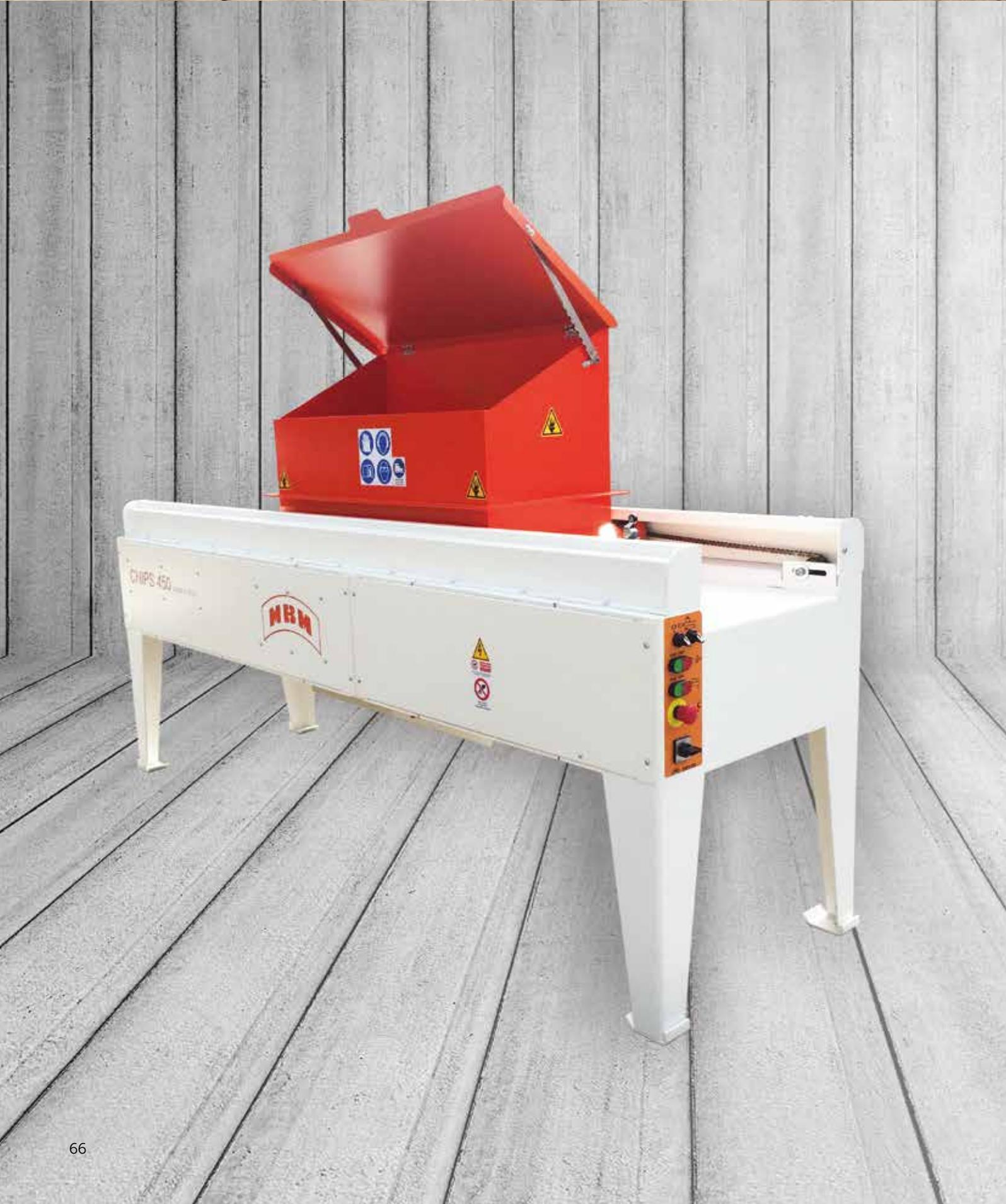
La piallatrice **CHIPS 450**, macchina all'avanguardia ed **ecologica**, permette di trasformare il legno di scarto in trucioli che possono essere utilizzati per le più svariate applicazioni.
